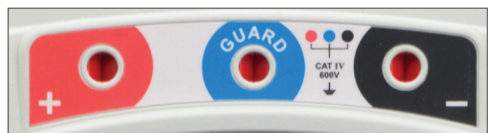
Abbildung 30: Die Megger MIT-Modelle stellen sicher, dass aus Sicherheitsgründen die CAT-Einstufung für alle Anschlüsse gilt. Einige der heute auf dem Markt befindlichen Geräte sind irreführend.
